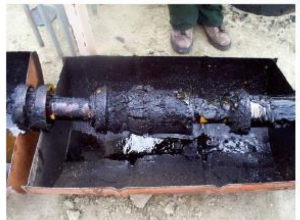
Fig. 11. Instrumentul de măsură nu trebuie transformat în instrument de curățire.
