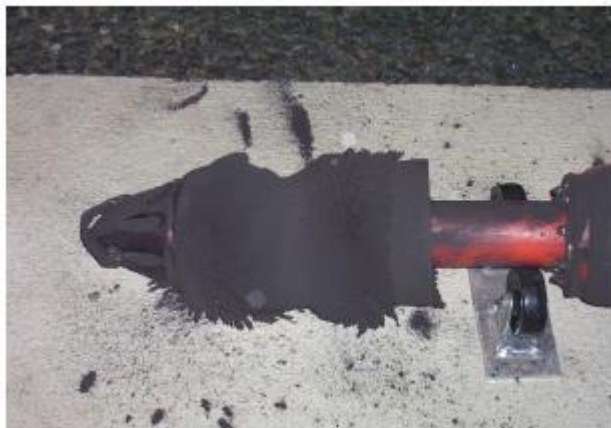
Fig. 11. Instrumentul de măsură nu trebuie transformat în instrument de curățire.
