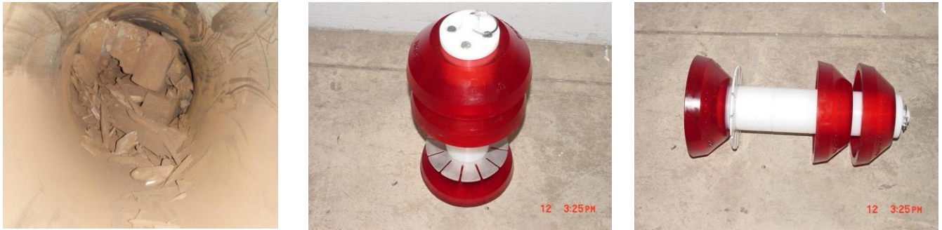
Fig. 2. PIG-uri pentru îndepărtarea materialelor din conducte.
