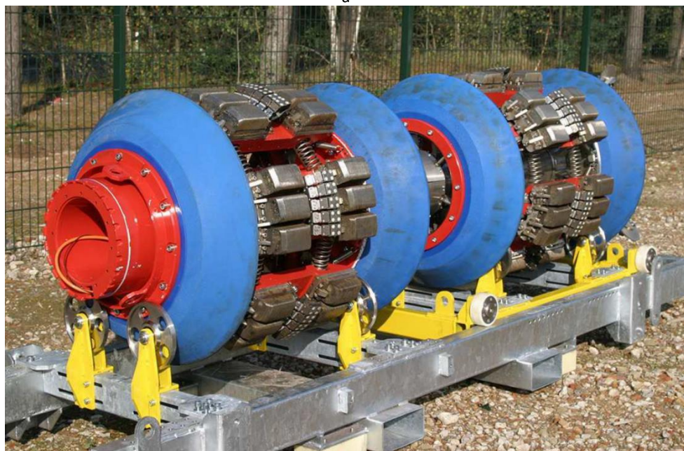
Fig. 22. Sistem PIG a) cu ultrasunete; b) cu flux magnetic
