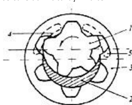
Fig. 4. Pompă cu roți dințate cu angrenare interioară.
